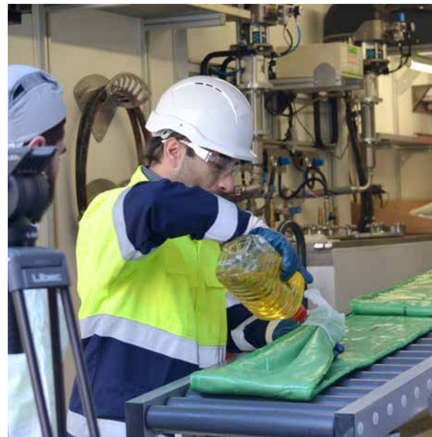
De liner wordt ingesmeerd met olie om het inbrengen te vergemakkelijken.
